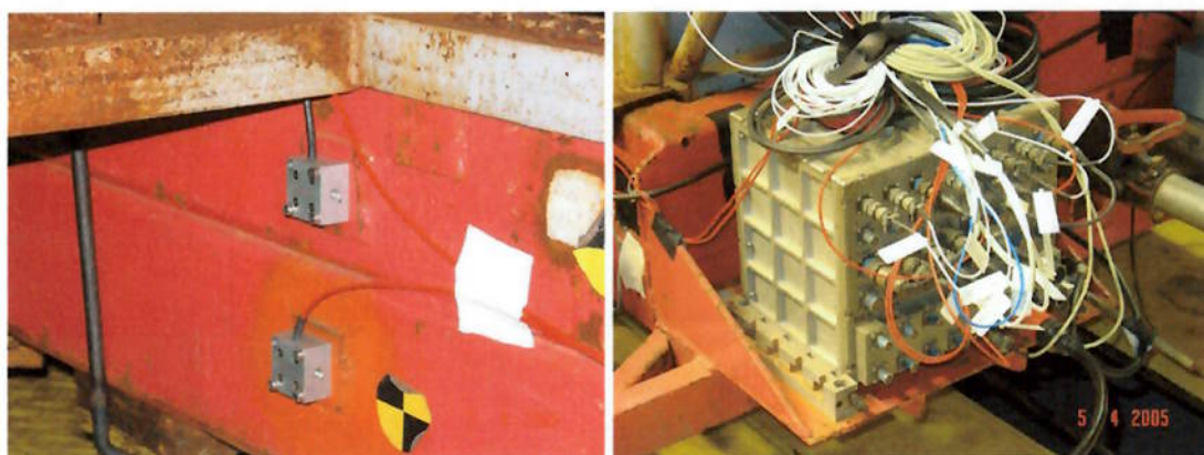
Figura 7.9 Posicionamento dos acelerômetros e sistema de aquisição Hentschel
