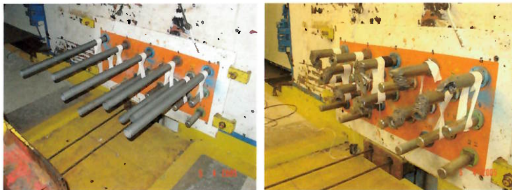
Figura 1.3 Tubos antes e após o impacto
