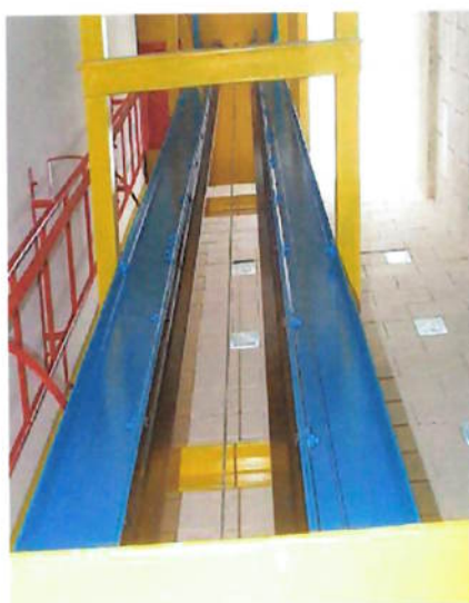
Figura 7.1 Martelo de queda livre do GMSIE
